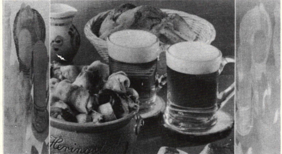
Afb. 1. Een door een zwart-wit telefoto-ontvanger geregistreerde kleurenafbeelding. In het midden is de grijstooninformatie (Y) te zien en links en rechts hiervan de gecomprimeerde en gecodeerde kleurinformatie.
